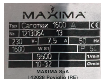
Moteur à haute vitesse: 9500 tours / Min
