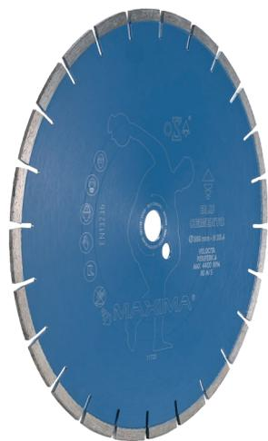
Recommandé pour une utilisation professionnelle non intensive, **Bleu Béton** assure d'excellentes performances en termes de coupe et de vitesse. Son segment fait 10 mm de haut et le disque est disponible avec des diamètres allant jusqu'à 500 mm. À utiliser sur les scies à moteur et les découpeuses thermiques, il est indiqué pour des utilisations occasionnelles mais professionnelles sur béton sec.
