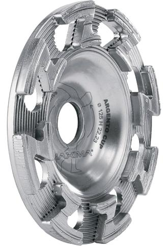
**Argent Cup** adapté aussi bien aux meuleuses qu'aux ponceuses. Sa forme spéciale et la position des trous entre les segments permettent une **meilleure extraction des poussières**, en les prenant au point de plus forte production et de concentration. La forme en «Z» du segment augmente considérablement la vitesse et le glissement. Pour des utilisations universelles dans le domaine du bâtiment ou spécifiques (marbre, granit) dans le domaine de la pierre.
