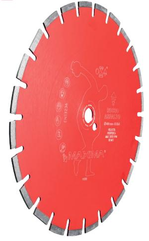
L'asphalte rouge est un disque diamant spécifique à l'asphalte, qui assure une bonne coupe et de la vitesse. La forme des boutonnières, longues et larges, facilite le déchargement des matériaux à emporter, la capacité de pénétration et le refroidissement. Le segment mesure 10 mm et le disque est disponible avec des diamètres pour les machines coupe-sol.
