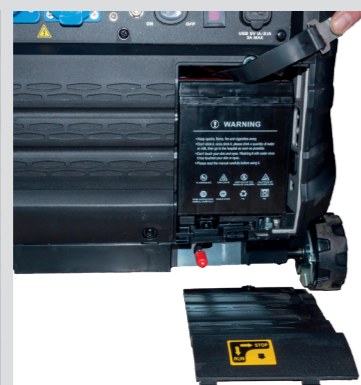
Batteria ad acido per l'accensione elettrica
