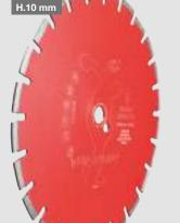
Rosso Asfalto è un disco diamantato specifico per l'asfalto, che assicura buona taglienza e velocità. La forma delle asole, lunghe e larghe, agevola lo scarico dei materiali da asporto, la capacità di penetrazione e il raffreddamento. Il segmento è alto 10 mm e il disco è disponibile con diametri per macchine tagliasuolo.
