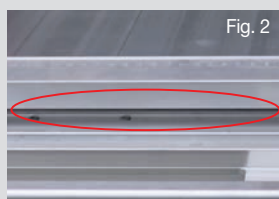
Fessura generosa sul banco
