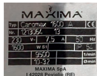
Motore ad alta velocità: 9500 Giri / Min
