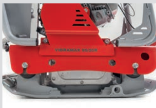
Vibrationsschutz am Sockel
