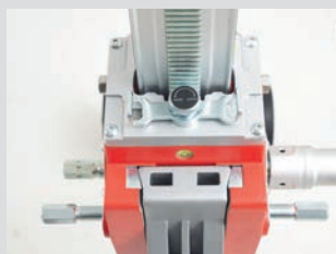
Sperrvorrichtung für den Gleitmechanismus
