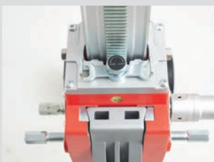
Sperrvorrichtung für den Gleitmechanismus
