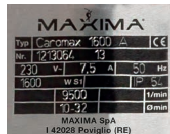
Hochgeschwindigkeitsmotor 9.500 Drehungen / Min.
