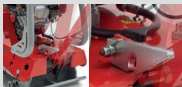
Sperrvorrichtung zum Heben und Senken des Handgriffs
