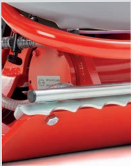
Stoßstange und Schraffierung für Ablaufrinne
