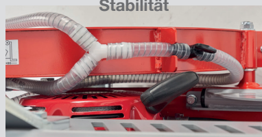
Doppelter Wasserschacht für eine bessere Kühlung der Trennscheibe
