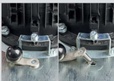
Kippbarer Hauptteller mit Sperrvorrichtung für Einzelrotation oder Solidarrotation
