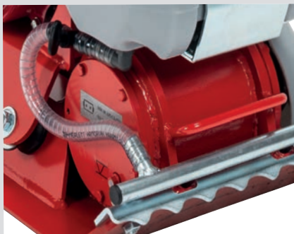
Barra de protección contra los golpes y moleteada para el goteo
