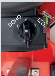
Interruptor con inversor de la dirección
