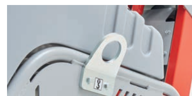
Enganche doble de elevación
