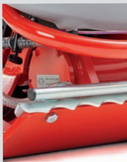
Barra de protección contra los golpes y moleteada para el goteo
