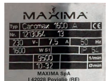
Motor de alta velocidad: 9500 rpm
