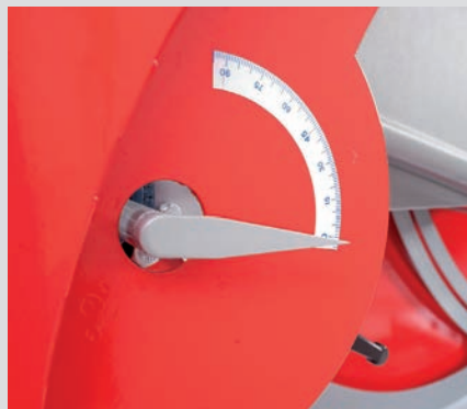
Indicador de profundidad de corte
