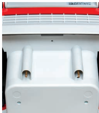
Sensores de agua debajo del motor
