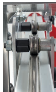
Cojinetes de acero que se deslizan sobre barras de acero dobles
