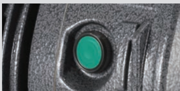
Botón de alimentación de la micropercusión
