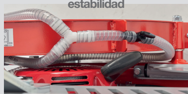
Entrada de agua doble para una mejor refrigeración del disco
