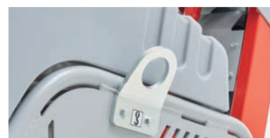
Double crochet de levage
