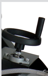
Réglage de la hauteur de coupe
