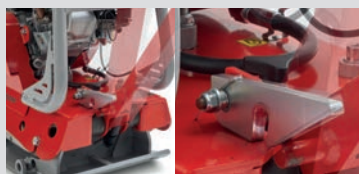
Arrêt pour lever/abaisser le guidon
