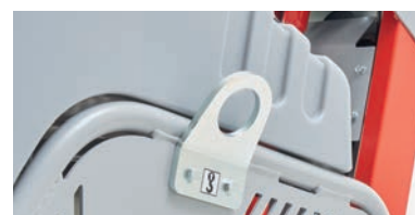
Double crochet de levage
