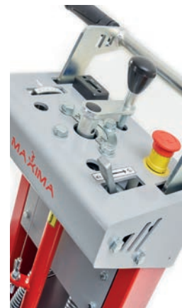
Réglable en profondeur et accélérateur avec verrouillage sur « point mort »
