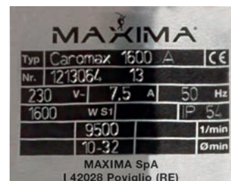
Moteur à haute vitesse: 9500 tours / Min
