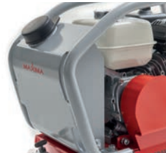
Réservoir d'eau inclus dans le réservoir
