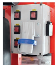
Monophasé à 3 moteurs plus 1 moteur secoue-filtre
