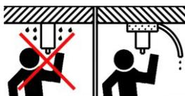
Trapanazione in verticale verso l'alto deve essere effettuata solo con dispositivo di raccolta dell'acqua.
