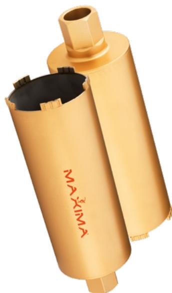
Il foretto ASPIRAZIONE300 è l'utensile della gamma idoneo a consentire lavorazioni che richiedano l'aspirazione delle polveri. Anche il Foretto Aspirazione 300 monta lo stesso segmento diamantato dei foretti lunghi 150 mm e perciò è in grado di forare a secco materiali come cemento armato, laterizi, tegole e calcestruzzo.
