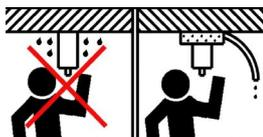
Trapanazione sopra-testa deve essere effettuata solo con dispositivo di raccolta dell'acqua.
