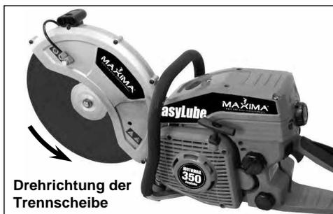
Die Drehrichtung der Trennscheibe verläuft stets wie oben durch den Pfeil angegeben – unabhängig davon, ob die Trennvorrichtung in Mittel- oder Außenposition montiert ist.
