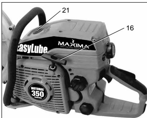
Cuando se acciona la válvula de descompresión (21) en la cámara de combustión del motor se alcanza una compresión más baja. Esto significa que el motor, cuando se inicia, encuentra una resistencia opuesta más pequeña y por lo que el arranque se facilita considerablemente.
