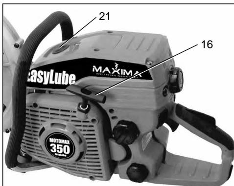
Terwijl het decompressieventiel ingedrukt is (21) wordt in de verbrandingskamer van de motor een kleinere compressie verkregen. Dit betekent dat de motor tijdens het starten een kleinere weerstand uitoefent en dat het aanslingeren duidelijk gemakkelijker wordt.
