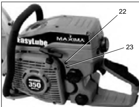
Bij een correcte stationaire toerentalinstelling moet de motor bij stationair toerental ronddraaien zonder dat de zaagschijf wordt aangedreven.
