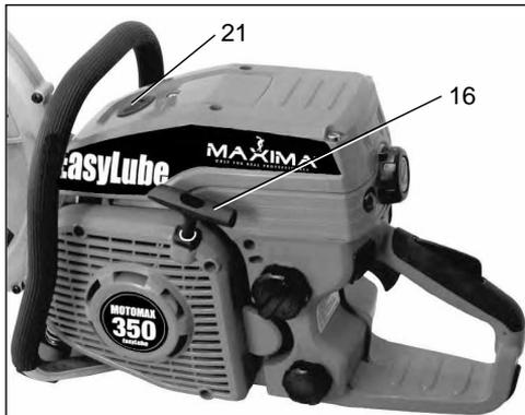
Bei betätigtem Dekompressionsventil (21) wird im Brennraum des Motors eine geringere Verdichtung erzielt. Dies bedeutet, dass der **Motor beim Starten eine kleinere Widerstandskraft** entgegen setzt und so das **Anwerfen merklich erleichtert** wird.
