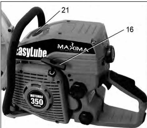
Attivando la valvola di decompressione (21) si ottiene una compressione minore all'interno della camera di combustione del motore. Questo significa che il motore all'accensione offre una resistenza minore semplificando notevolmente l'avviamento.
