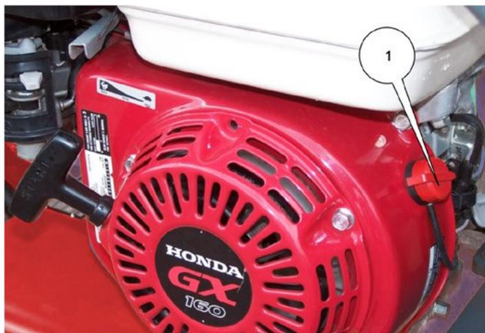
3. Collocare il dispositivo di avviamento a freddo in posizione ON (1). Non utilizzare il dispositivo di avviamento a freddo a motore caldo o a temperatura ambiente elevata.
