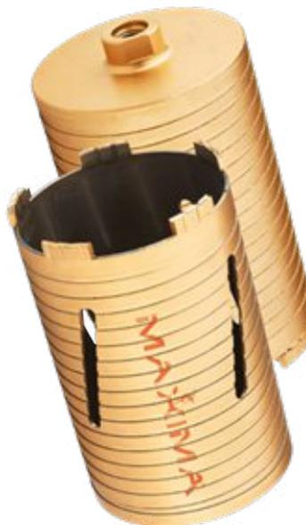
Las características del equipo pueden consultarse en el Manual de uso y mantenimiento. La broca de Ø 205 LASER ORO SPIRAL es suministrada por Maxima para la perforación en seco del cemento armado. Está equipada con una espiral y el cuerpo cónico tiene un segmento moleteado con un diseño cóncavo/convexo que le permite reducir la fricción y descargar mejor el material extraído, mejorando así la velocidad de perforación.
