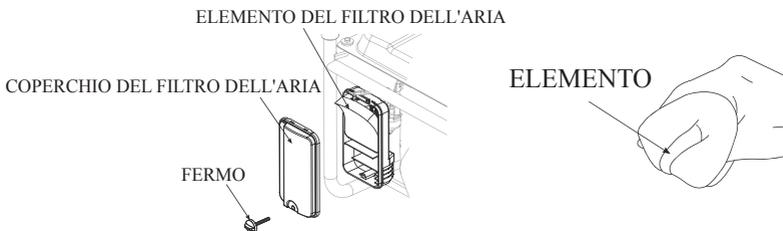
(3) Reinstallare l'elemento del filtro dell'aria e il coperchio
