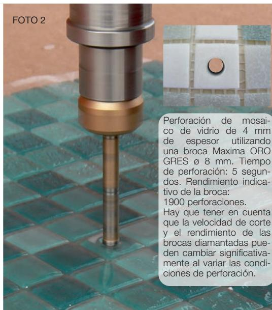
Perforación de mosaico de vidrio de 4 mm de espesor utilizando una broca Maxima ORO GRES ø 8 mm. Tiempo de perforación: 5 segundos. Rendimiento indicativo de la broca: 1900 perforaciones. Hay que tener en cuenta que la velocidad de corte y el rendimiento de las brocas diamantadas pueden cambiar significativamente al variar las condiciones de perforación.
