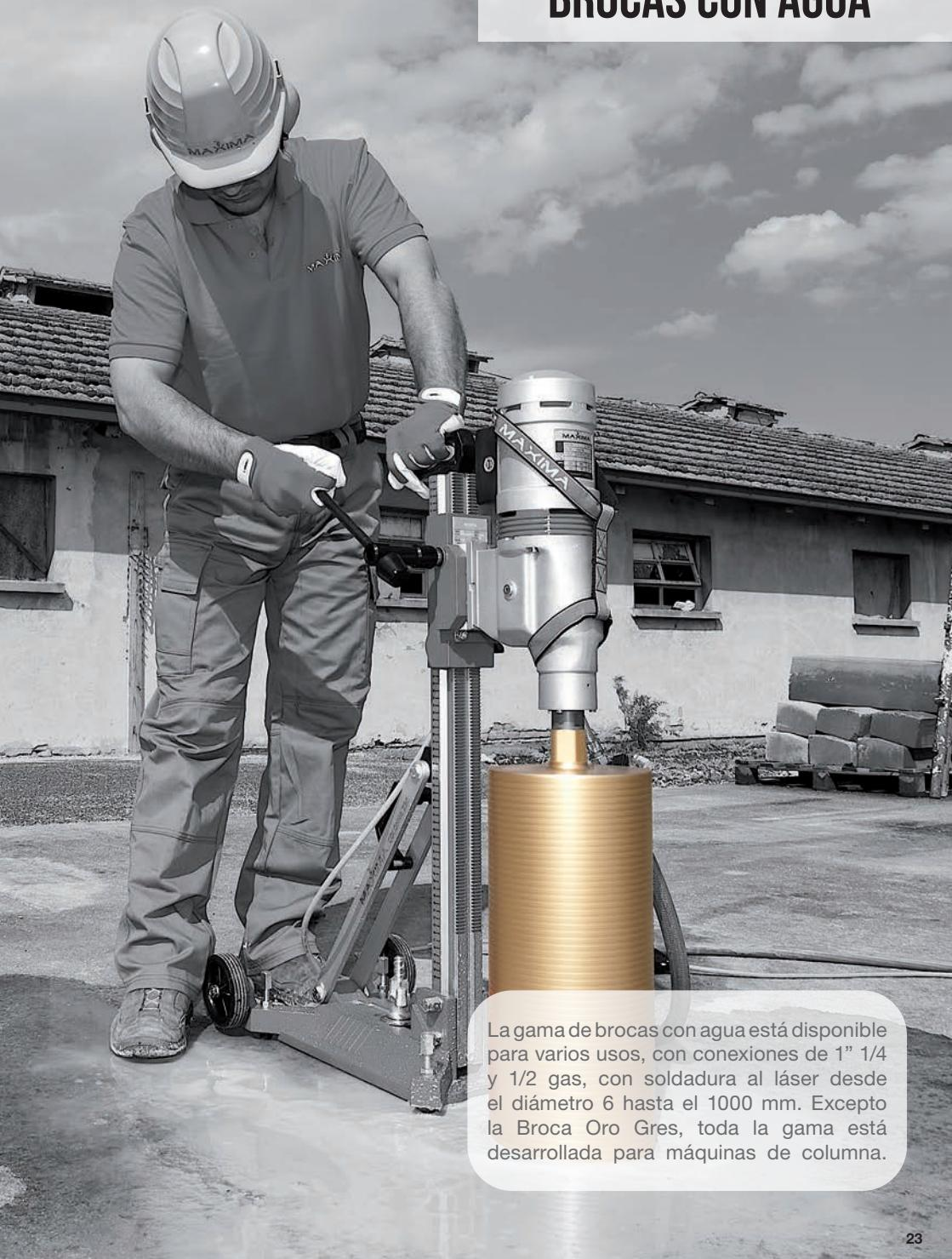
La gama de brocas con agua está disponible para varios usos, con conexiones de 1" 1/4 y 1/2 gas, con soldadura al láser desde el diámetro 6 hasta el 1000 mm. Excepto la Broca Oro Gres, toda la gama está desarrollada para máquinas de columna.
