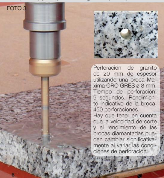
Perforación de granito de 20 mm de espesor utilizando una broca Maxima ORO GRES ø 8 mm. Tiempo de perforación: 9 segundos. Rendimiento indicativo de la broca: 450 perforaciones. Hay que tener en cuenta que la velocidad de corte y el rendimiento de las brocas diamantadas pueden cambiar significativamente al variar las condiciones de perforación.
