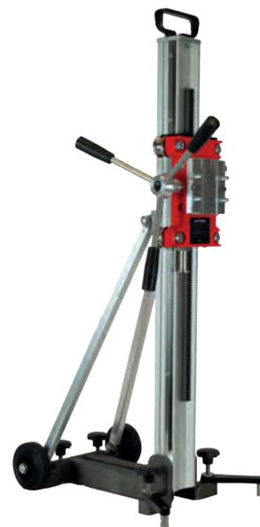
Colonna Special 300 inclinabile per carotatrice diametro massimo 300 mm con base in alluminio. Cremagliera, cuscinetti e scorrimento in acciaio.
