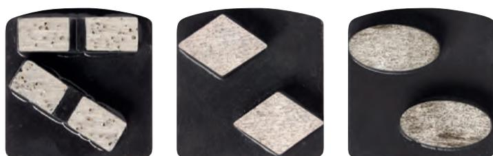
I **Grinder Neri** sono moduli adatti per la levigatura di **cemento molto abrasivo**. Disponibili per 3 tipologie di lavorazione: grezzo, semifine e fine e nelle seguenti grane: 16-18, 30-40, 60-80, 80-100 e 120-140. Da utilizzare con le levigatrici professionali Levimax 280 e Levimax 550.
