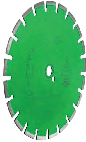
**Verde Asfalto** è un disco diamantato *specifico per l'asfalto*, che assicura **buona taglienza e velocità**. La forma delle asole, lunghe e larghe, agevola lo scarico dei materiali da asporto, la capacità di penetrazione e il raffreddamento. Il segmento è alto 10 mm e il disco è disponibile con diametri per macchine tagliasuolo.
