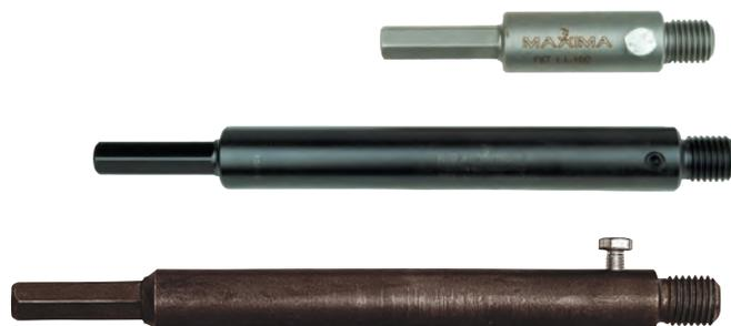
Realizzati in acciaio di qualità superiore ed idonea a sopportare le elevate sollecitazioni torsionali che si trasmettono e concentrano nei punti di attacco, gli **Attacchi Esagonali** sono disponibili in lunghezza 110, 220, 370 e 450 mm. Da utilizzare con foretti a secco ad attacco M16 montati su carotatori manuali con mandrino a cremagliera.
