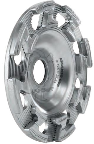
**Argento Cup** è adatto sia per smerigliatrici che levigatrici. La speciale forma e la posizione dei fori fra i segmenti permette una **migliore estrazione delle polveri** prendendole proprio nel punto di maggior produzione e concentrazione. L'esclusiva forma a "Z" del segmento ne aumenta notevolmente velocità e scorrevolezza. È ideale per lavorazioni sia con macchine smerigliatrici che levigatrici manuali e per utilizzi universali in ambito edile oppure specifici in ambito lapideo.
