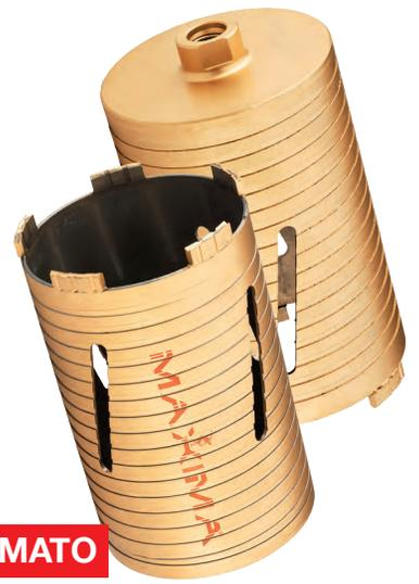
**Per Trapano.** Per gres porcellanato e ceramiche in genere. Per trapani con mandrino da 13 mm, senza percussione. Numero di giri minimo ottimale 1.500 giri/min. Per una resa superiore raffreddare durante la foratura estraendo e reinserendo ripetutamente l'utensile nel foro. Iniziare la foratura con un'angolazione di 45°, procedere poi con movimento circolare.
