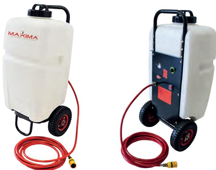
Per carotaggi ad acqua di piccolo e medio diametro. **Tanica con Pompa Elettrica** è da utilizzare in mancanza di una comoda sorgente d'acqua nel sito di lavorazione. La pressione per l'erogazione dell'acqua viene ottenuta con pompa elettrica alimentata da una batteria da 12 V. Il flusso acqua è di 4 L/min. La capienza di 40 litri e il peso contenuto in soli 19 Kg la rendono facilmente trasportabile. - Dimensioni: 43,5 x 36 x 89 cm. Fornita con il tubo acqua di lunghezza 6 metri.
