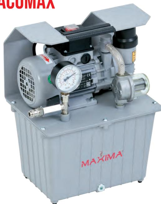
**Vacumax** è un depressore per il fissaggio delle carotatrici dotate di basamento predisposto con guarnizioni di tenuta del sottovuoto, ad esempio le *Caromax 200* e *250*. In questo modo viene evitato il danneggiamento della superficie di lavorazione, fosse ad esempio un pregiato pavimento in marmo o granito. Non adatto per superfici traspiranti.
