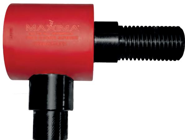
Le **Teste Rotanti** sono l'accessorio principale per realizzare l'aspirazione delle polveri durante le forature con foretti con attacco 1"1/4 e lunghezza massima di 300 mm. La realizzazione in alluminio e il montaggio su cuscinetti a bassissimo attrito garantiscono che la massima potenza del motore della carotatrice venga trasferita al foretto diamantato. Sono disponibili con filetti M18, 1/2 GAS, 1"1/4 e 5/8. Da utilizzare con i foretti *Aspirazione 300*.
