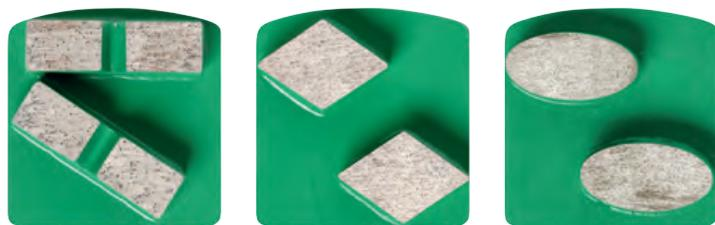
I **Grinder Verdi** sono moduli sviluppati per la levigatura di **cemento duro**. Disponibili per 3 tipologie di lavorazione: grezzo, semifine e fine e nelle seguenti grane: 16-18, 30-40, 60-80, 80-100 e 120-140. Da utilizzare con le levigatrici professionali Levimax 280 e Levimax 550.
