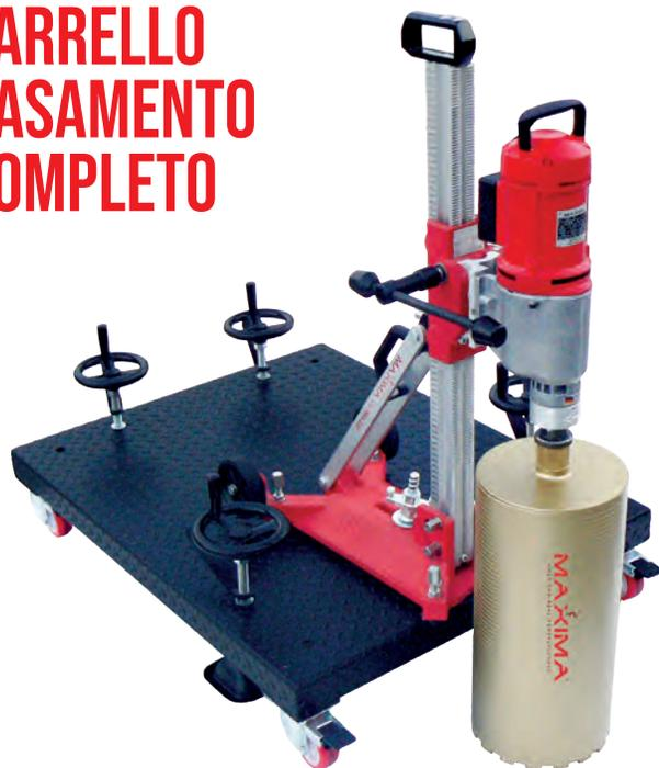
Il **Carrello Basamento Completo** è una attrezzatura di supporto costruita per gli utenti che necessitano di praticare fori a pavimento con **carotatrici su colonna**. Montando le carotatrici su questo carrello, viene evitato il tassellaggio a pavimento, rendendo più veloci le forature e gli spostamenti.
