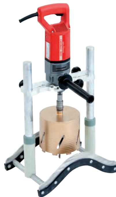
La **Colonna Tubo** semplifica la foratura manuale su superfici ricurve, quali ad esempio tubazioni in cemento, anche se già posati in opera, abbracciandone il diametro e fornendo una solida sede cui fissare la carotatrice. Il diametro del collare è di 43 o 60 mm, rendendola così utilizzabile con le carotatrici manuali di ogni marca e con Caromax 1600, Caromax 1800, Caromax 2000 ASP, Caromax 2001, Caromax 210 A e Caromax 2000.
