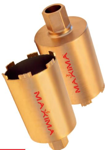
È l'utensile della gamma idoneo a consentire lavorazioni che richiedano l'aspirazione delle polveri. Anche il Foretto aspirazione 150 monta lo stesso segmento diamantato dei foretti lunghi 300 mm ed è perciò in grado di forare a secco, materiali come cemento armato, laterizi, tegole e calcestruzzo. La lunghezza utile di taglio è 150 mm.
