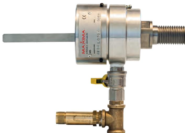
Il giunto rotante GIUNTOMAX è utilizzato per il carotaggio continuo ad aria e/o aerosol. Garantisce un miglioramento delle prestazioni in termini di raffreddamento dell'utensile e capacità di asportazione del detrito, determinando una maggior durata dell'utensile, in particolar modo per i diametri più grandi e su materiali molto duri quali granito, quarzite e arenarie dure.
