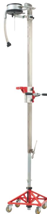
La **Colonna Telescopica 250 Deluxe** nasce per ospitare *Caromax 200* e *Caromax 250* e realizzare così forature in orizzontale quando non è possibile forare la parete per il fissaggio a tassello o a ventosa di una delle due carotatrici. Dotata di kit raccogliacqua e di 2 molle a gas che aiutano le regolazioni in altezza. Per facilitarne gli spostamenti, il basamento è predisposto con 4 ruote.
