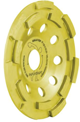
Segmenti trapezoidali e zigrinati sul senso di rotazione e fori in prossimità dei segmenti rendono **Bianco Cup** un platorello veloce ma agile mantenendo una buona qualità di abrasione. Unisce forza e precisione inserendosi in una fascia intermedia molto apprezzata da chi leviga frequentemente. È ideale per lavorazioni sia con macchine smerigliatrici che levigatrici manuali e per utilizzi universali in ambito edile oppure specifici in ambito lapideo.
