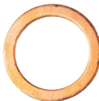
Gli **Anelli Anti-Block** sono disponibili in due misure, ovvero per l'uso con foretti ad attacco M16 e 1"1/4 e sono realizzati in rame. Posizionati tra l'attacco ed il foretto oppure tra mandrino della carotatrice e attacco, come le normali rondelle metalliche facilitano lo smontaggio degli elementi (attacco e foretto) a fine lavorazione.
