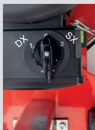
Interruttore con invertitore di direzione
