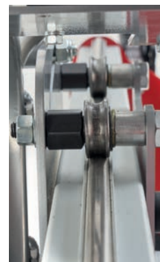
Cuscinetti acciaio che scorrono su doppie barre in acciaio
