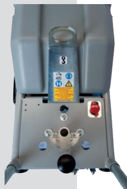
Regolabile in profondità ed acceleratore con blocco su "folle"
