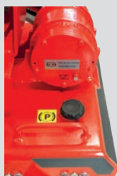
Blocco rulli per trasporto in sicurezza
