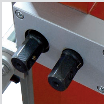
Sistema di avanzamento a doppia velocità del carrello motore
