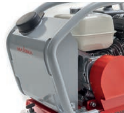
Serbatoio acqua incluso
