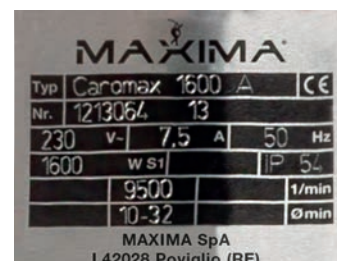
Motore ad alta velocità: 9500 Giri / Min
