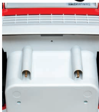
Sensori acqua sotto al motore
