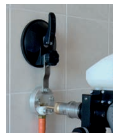
Kit di centraggio e raccolta dell'acqua
