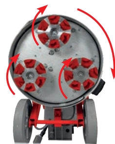
Da 9 a 18 moduli con piatti satellitari che possono ruotare singolarmente o solidali al piatto
