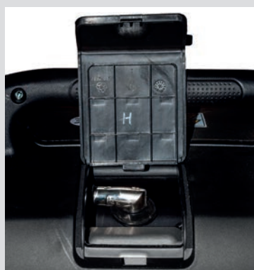
Facile accesso per la manutenzione della candela
