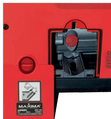
Facile accesso per la manutenzione dell'olio
