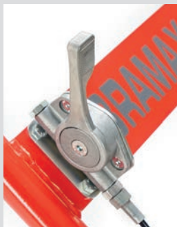
Leva acceleratore con blocco in "follie"
