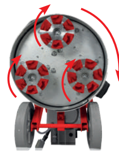
De 9 à 18 modules avec des plaques satellite qui peuvent tourner individuellement ou solidairement à l'assiette
