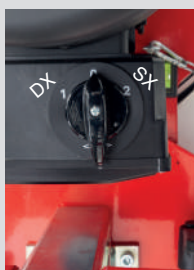
Interrupteur avec inverseur de direction
