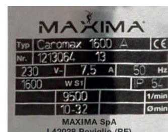
Moteur à haute vitesse: 9500 tours / Min
