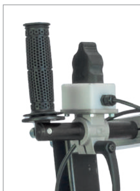
Joystick déplacement avant et arrière
