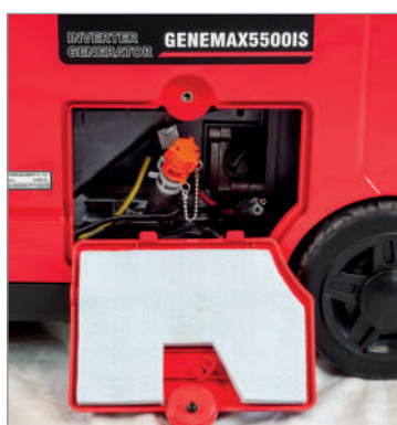
Accès facile pour le contrôle de l'huile
