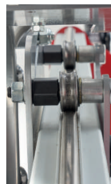
Roulements en acier sur barres doubles en acier
